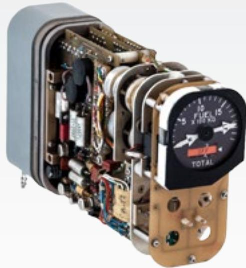
Die Anzeigewahl erfolgt dabei über die Vorratsanzeigewahl-taste auf der Frontseite des Geräts. Das Gerät dient ferner als Muttergerät für einen nachgeschalteten Kraftstoffvorratsanzeiger, sowie als Geber für ein Datensichtgerät und ein Fernanzeigesystem.
